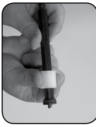
Étape 4a pour (TD100 - 1% et TD200 - 0.5%) Remplacez le bout évasé du PISTON DOSEUR n° 44 et le joint torique n° 14.
