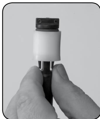
Étape 4 pour (1% & 0.5%) Appuyez sur les languettes et retirez le piston doseur.
